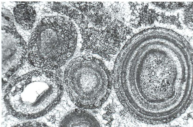
Abb. 38 Gut sortierter Oosparit. Die Ooide und das sparitische Bindemittel sind z.T. dolomitisiert (dunkle zuckerkörnige Verdrängungen). Links unten ist ein (helles) Quarzkorn der Kristallisationskeim für die Ooidbildung. DS 97/75e, Bildbreite 2,6 mm, PPL. Lesestein am SW-Hang des Malyj Thač unterhalb des Gipfels bei 2050 m ü. HN (Foto: O. Tietz).
