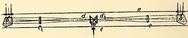
Fig. 8 Strahlengang im Entfernungsmesser.
