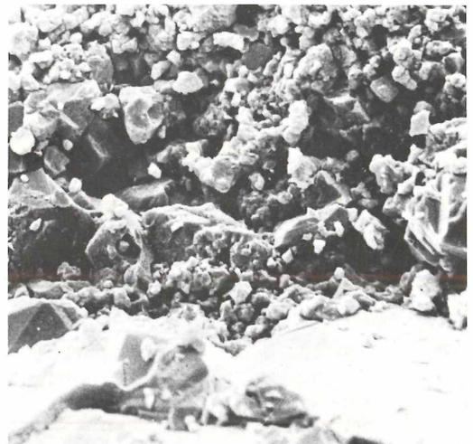
Abb. 12: Kontakt zwischen Sparitfüllung der Ammonitenwohnkammer und Matrix mit einer ca. 300 Mikron breiten Zone größerer Kristallite. Probe E1/X-5; REM-Foto 4311 (600  $\times$ ) bzw. 4308 (1700  $\times$ )
