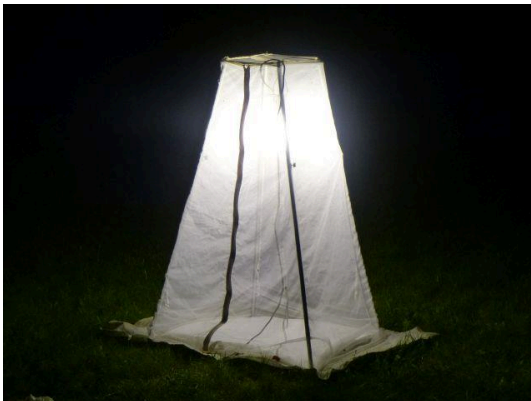
Abb.1: Leuchtturm mit einer generatorbetriebenen 550W HWL-Lampe.
