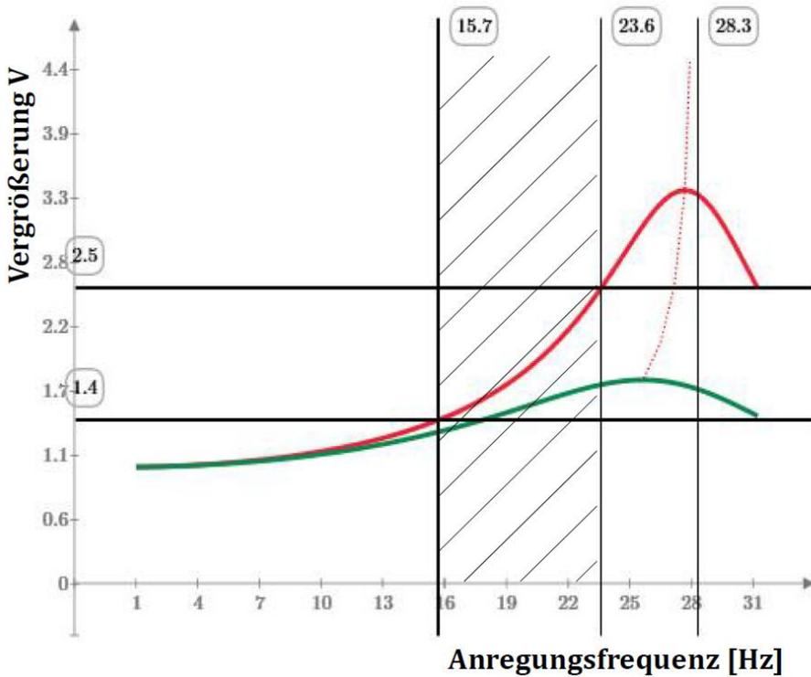
Diagramm 5: Vergrößerungsfunktion bei 28,3 Hz Asteigenfrequenz und Schwingungsanregung im Frequenzbereich des Spechtes von 15,7 bis 23,6 Hz
