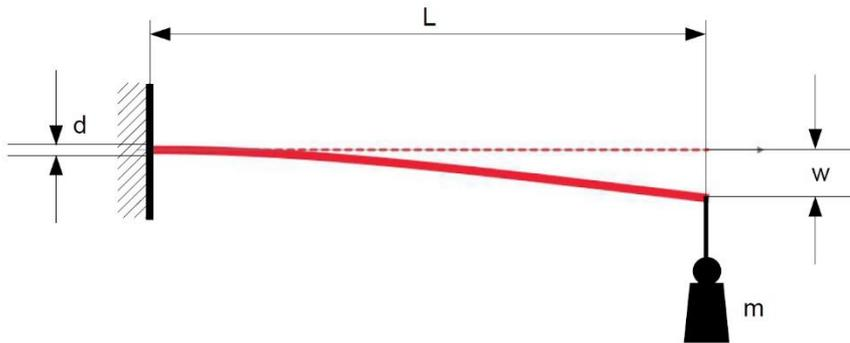
Abb. 6: Versuchsaufbau zur Ermittlung des E-Moduls
