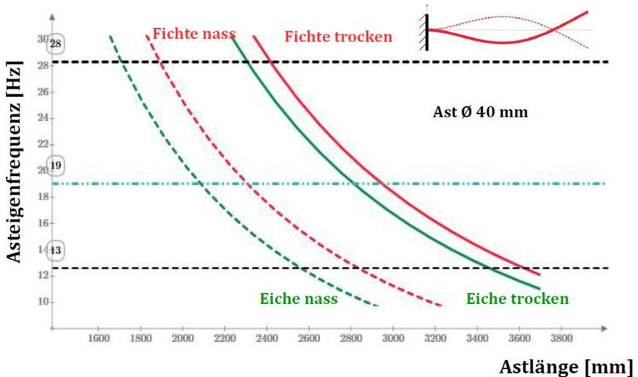
Diagramm 7: Asteigenfrequenz bei Fichte und Eiche im nassen und trockenen Zustand bei  $d=40$  mm in der 1. Oberschwingungsform in Abhängigkeit der Astlänge.
