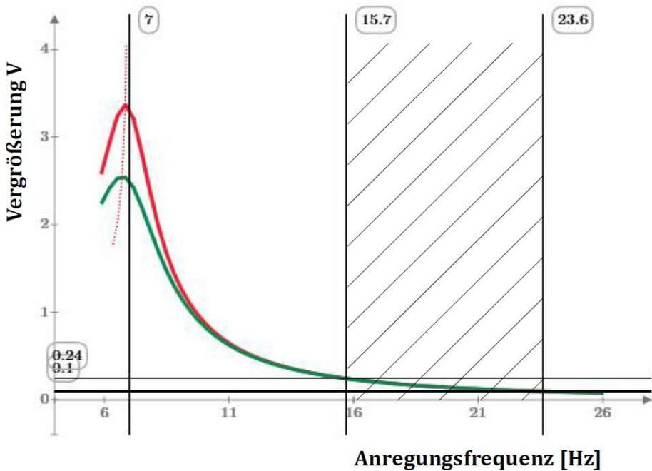
Diagramm 9: Vergrößerungsfunktion bei 7 Hz Asteigenfrequenz und Schwingungsanregung im Specht Frequenzbereich 15,7 Hz/ 23,6 Hz
