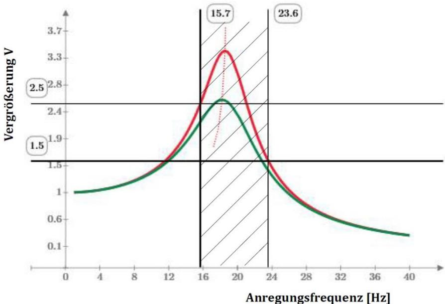
Diagramm 3: Vergrößerungsfunktion bei 19 Hz Asteigenfrequenz und Schwingungsanregung im Frequenzbereich des Spechtes von 15,7 bis 23,6 Hz bei 2 Dämpfungswerten
