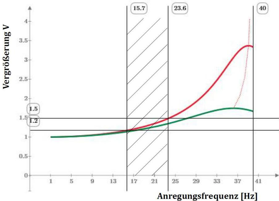
Diagramm 10: Vergrößerungsfunktion bei 40 Hz Asteigenfrequenz und Schwingungsanregung im Specht Frequenzbereich 15,7 Hz/ 23,6 Hz
