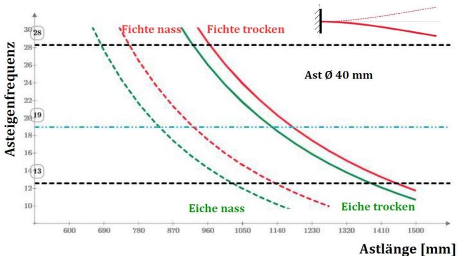
Diagramm 6: Asteigenfrequenz bei Fichte und Eiche im nassen und trockenen Zustand bei  $d=40$  mm in Grundschiwingungsform in Abhängigkeit der Astlänge.
