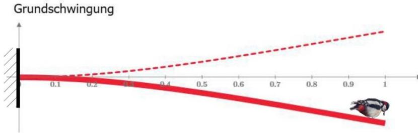
Abb. 4: Grundschiwingungsform mit der günstigen Trommelstelle des Buntspechtes
