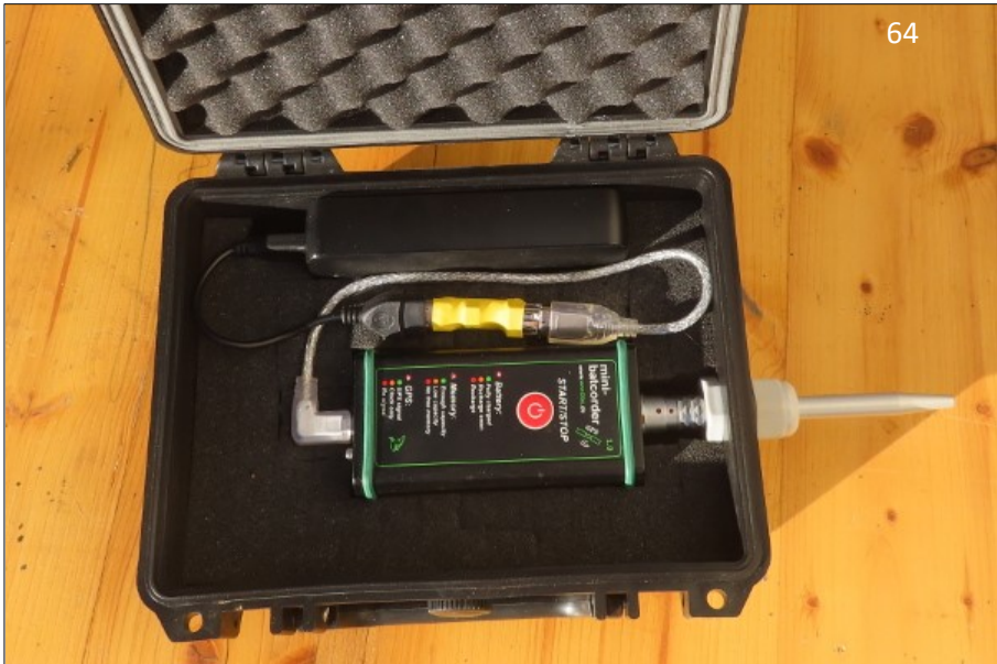
Abb. 64: MiniBC mit Powerbank im regensicheren Koffer
