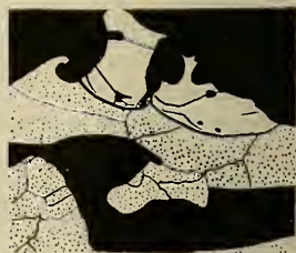
Fig. 4. Eisen, von Magnetit randlich umwachsen. Vergr. 134.
