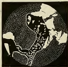
Fig. 1. Reliktstruktur von Magnetkies in schlackigem Magnetit (links unten auch etwas gediegenes Eisen). Vergr. 500.
