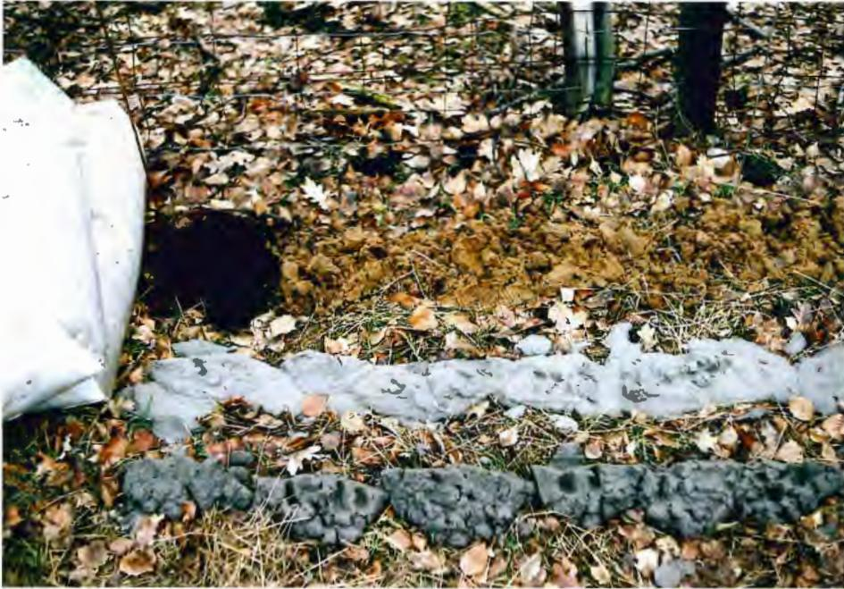
Abb. 5: Bohrgut aus dem Multilevel-Brunnen ML 1. Der Probenahmeabstand beträgt 1 m. Die unterschiedliche Färbung wird durch Austrocknung an der Luft deutlich.
