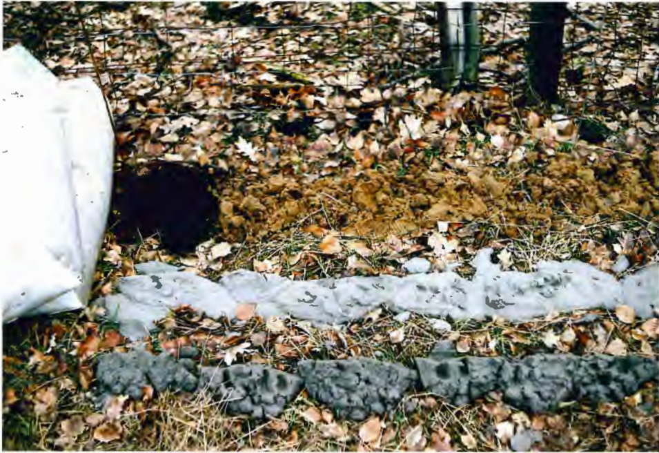
Abb. 5: Bohrgut aus dem Multilevel-Brunnen ML 1. Der Probenahmeabstand beträgt 1 m. Die unterschiedliche Färbung wird durch Austrocknung an der Luft deutlich.
