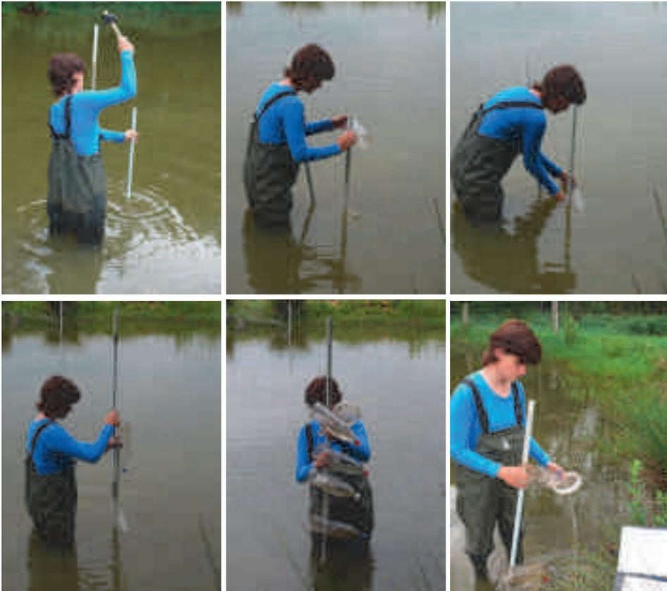
Abb. 8a-f: Auslegen und Einholen der Fallen; a: Befestigung des Haltestabes; b: Anbringung der Flaschenreusen; c: Absenken der schräg gestellten Flaschenreusen (mit Luftreservoir gegenüber der Öffnung); d: Schieben der Reuse in die gewünschte Position, Abmessung mittels Messstab; e: beim Herausholen werden die Flaschen gekippt, der Inhalt bleibt zunächst in der Flasche; f: Er wird dann für jede Flasche einzeln über einem Plastiksieb ausgeleert. Fotos: M. Schlüpmann.
