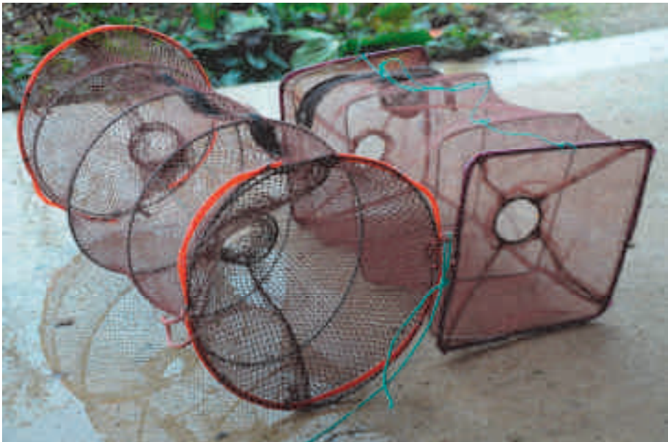
Abb. 1a: Kormoran-Reuse (links) und Pafex-Reuse (rechts). Kormoran-Reuse mit trichterförmigen, 30 cm langen Eingängen. Die Trichteröffnungen haben einen Durchmesser von 50 mm. Die Netzmaschen sind mit 10 x 8 mm sehr groß. Pafex-Reuse mit zwei flachen Eingangstrichtern, einem Öffnungsdurchmesser von 60 mm und einer Maschenweite von 3 x 3 mm. Foto: St. Bellenoue.
