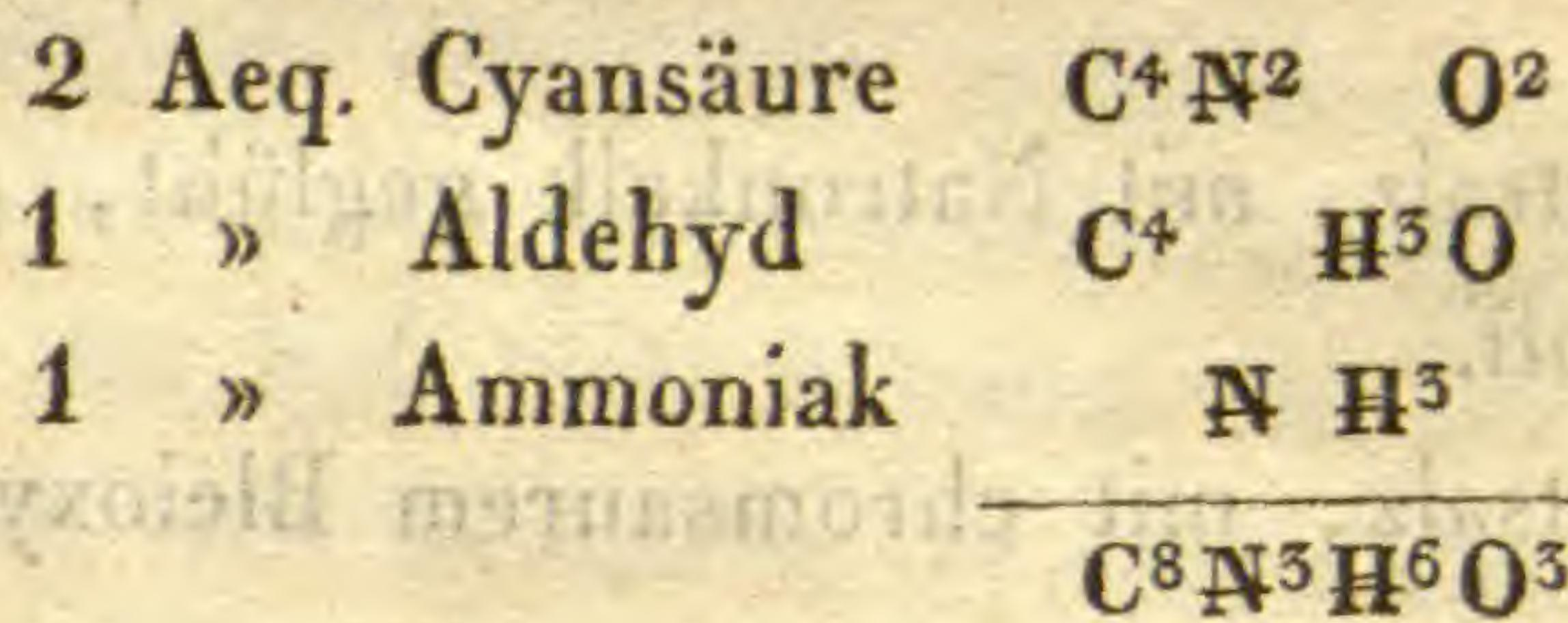
Das basische Wasseratom mitgerechnet, enthält sie die Elemente von 1 At. Harnstoff und 1 At. cyansaurem Acetyloxyd (Aldehyd).
