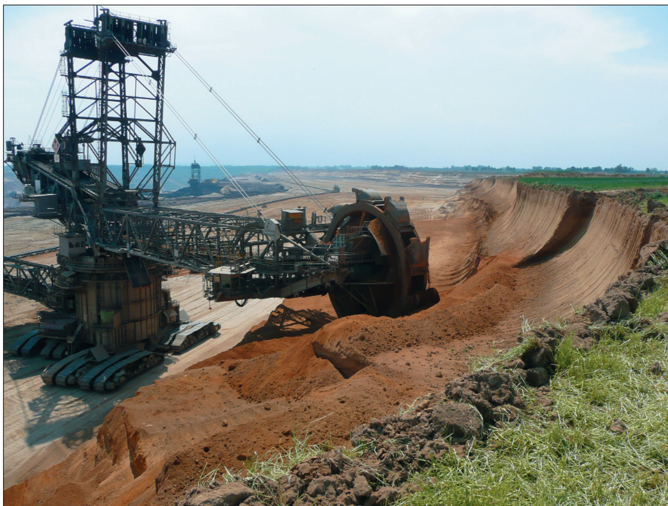
Abb. 1. Abbau der Lössdeckschichten im Braunkohlentagebau Garzweiler (Nordfeld) durch den Schaufelradbagger.
