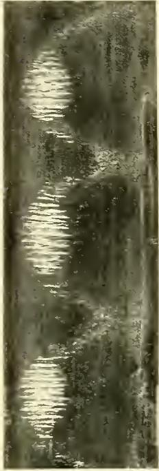
Wellen im Untersuchungsrohr  $p = 11.5$  Atm.  $t = 0^\circ$
