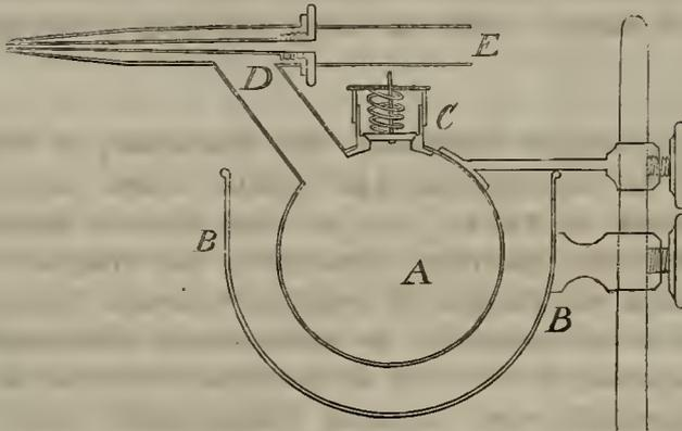
wöhnliches Sicherheitsventil mit einer Spirale angebracht wird. Ein solches ist namentlich dann sehr nützlich, wenn die untergestellte Lampe im Verhältnisse zur Oeffnung der Spitze (E) zu gross ist, sohin die sich zu rasch entwickelnden Dämpfe stark gegen die Innenwände des Gefässes drücken. Sie finden in diesem Falle durch das sich hebende Ventil und einige in dem Deckel befindliche Oeffnungen ihren Ausweg. Tritt aber eine noch heftigere Dampfwicklung oder auch eine Explo-
