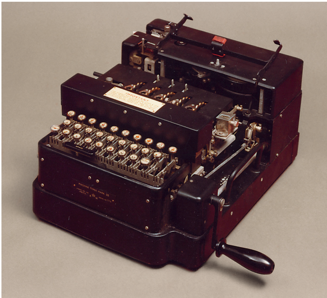
Abb. 5. Britische Chiffriermaschine Typex Mark III .
