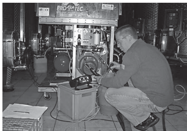
Messung des Sauerstoffeintrages während einer Weinfiltration
