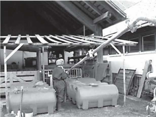
Die Prüfung des Aufsatzes zur Verminderung der Geruchsemissionen von Gülle erfolgte in 500 Liter-Regentanks.
