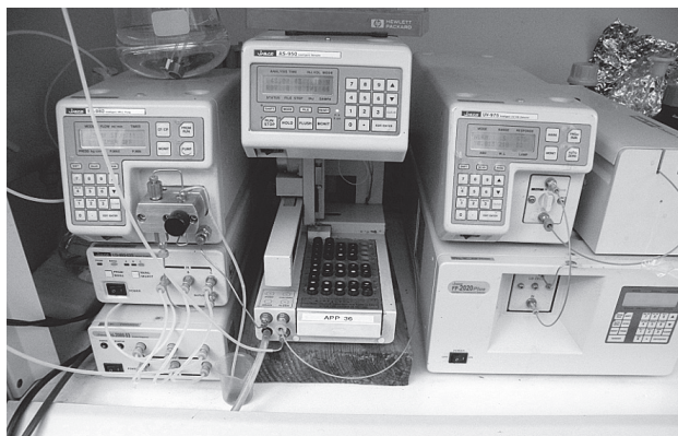
HPLC für die Bestimmung organischer Säuren
