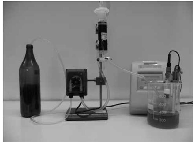
Abb. 1: Prototyp eines Kationentauschers für Versuchszwecke.
