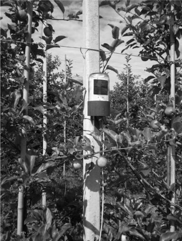
Abb. 1: Auf quelloffener Arduino-Technologie beruhendes Steuerungsmodul für die gezielte Bewässerung
