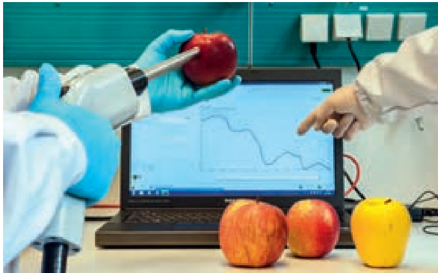
Nahinfrarot-Spektren an Äpfeln, die von einer fiberoptischen Sonde im Wellenbereich von 1.000 bis 2.500 nm aufgenommen wurden
