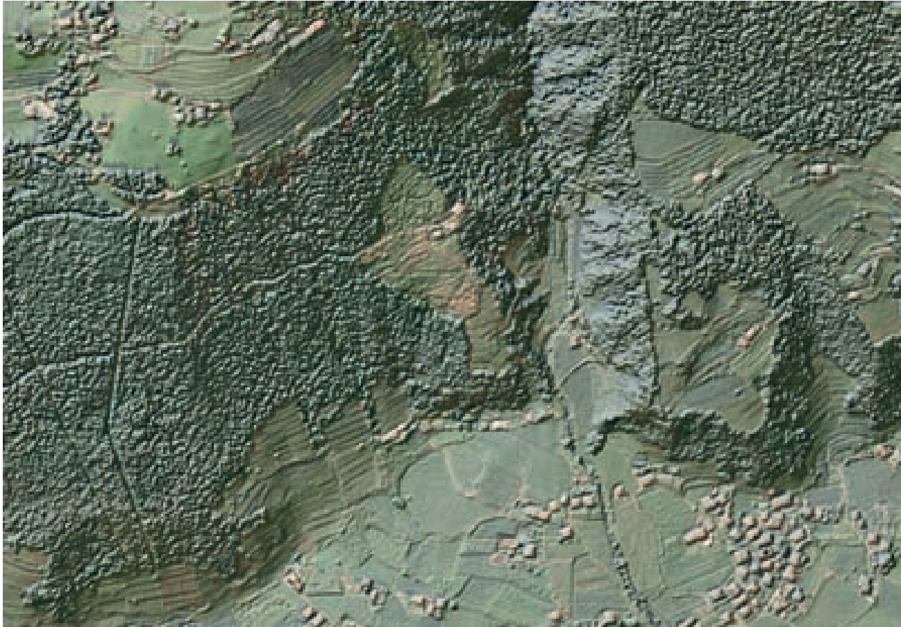
Verlässliche Daten über Dichte, Baumartenzusammensetzung und sogar Stammzahlen von Waldbeständen werden über Laserscan ermittelt
