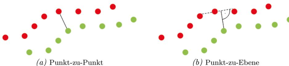
Abbildung 2.5.: Verschiedene Möglichkeiten der Zuordnung korrespondierender Punkte aus zwei Punktwolken für den ICP-Algorithmus mit Referenz- (rot) und transformierter Punktwolke (grün).
