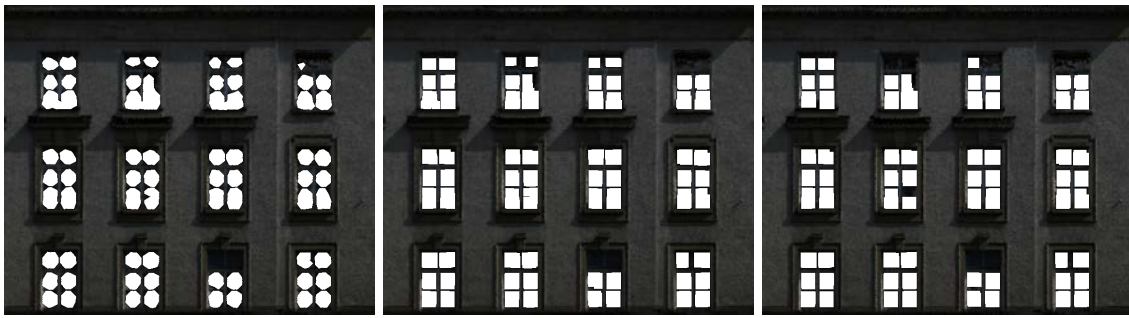
Abbildung 7.10: Eindruck einer geschlossenen Oberfläche durch Füllen der Zwischenräume mittels linearer Interpolation innerhalb von Dreiecksflächen (links), horizontaler/vertikaler benachbarter Pixel (Mitte) und der morphologischen Operation Schließen (rechts).
