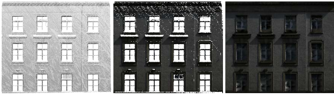
Abbildung 7.8: Durchlässige Oberfläche bei auf eine Textur projizierten Punkten (links) Zwischenrauminterpolation mittels Delaunay Dreiecksnetz mit Schwellwert für maximale Kantenlänge, bei zu gering gewähltem Schwellwert (Mitte) und zu hoch gewähltem Schwellwert (rechts).
