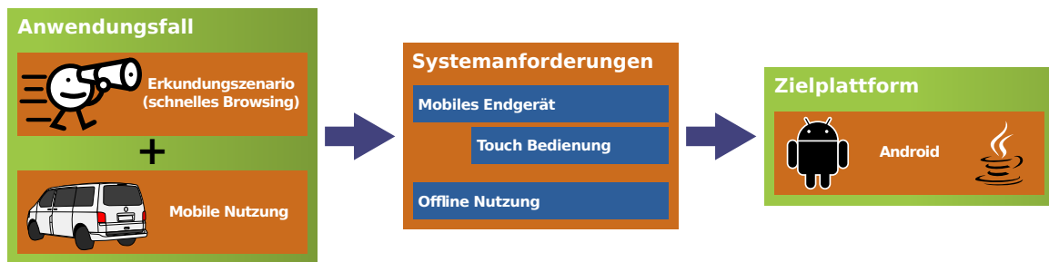
Abbildung 8.12: Übersicht über den Anwendungsfall und den daraus abgeleiteten Systemanforderungen, sowie der Zielplattform für die Visualisierung der 2D Fassadenmodelle.
