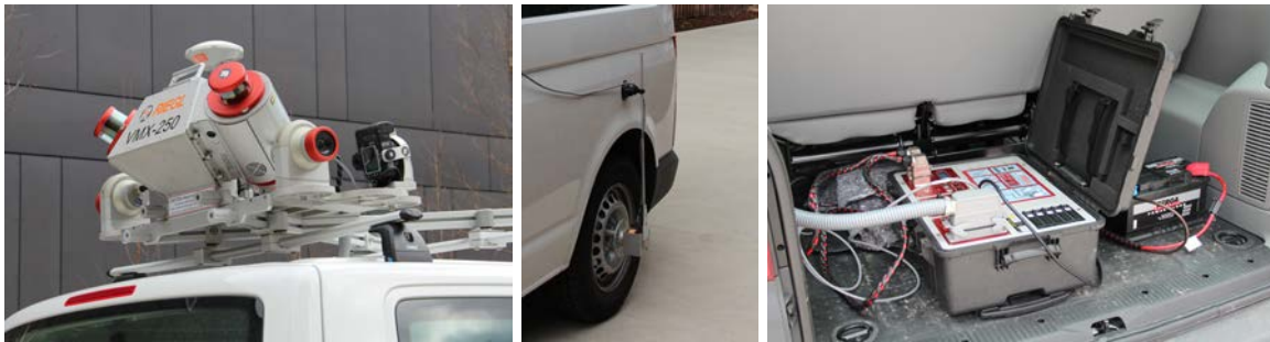
Abbildung 2.2: Komponenten der Mobile Mapping Plattform Riegl VMX-250, bestehend aus Messkopf und Kamerasystem (links), Distanz-Indikator DMI (mitte) und der Kontrolleinheit (rechts).
