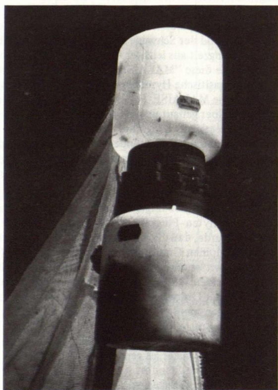
Abb. 5 : Automatischer Fangapparat der MALAISE - Falle (beide Fotos: W. Schedl)
