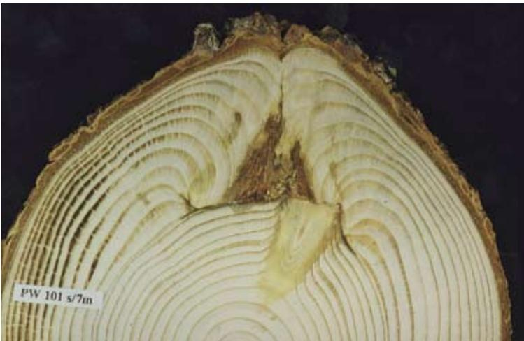
Abbildung 10. Extreme Überwallungsstörung an einem Fichtenstamm nach Rindenverletzung bei unsauber durchgeführter Ästung.
