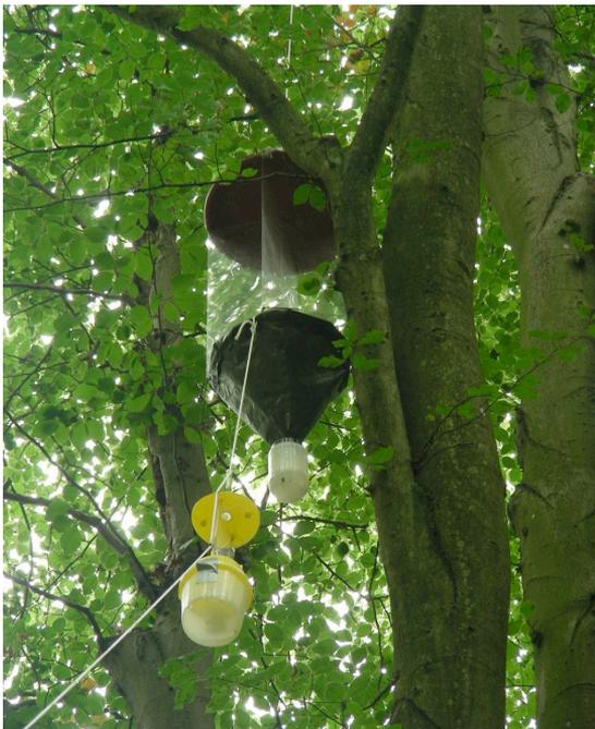
Abb. 2: Verwendeter Fallentypus (Kombination aus Kreuzfensterfalle und gelber Mini-Eklektor-Falle) im Einsatz.
