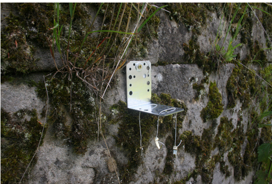
Abb. 7: Fanggefäß am Mauerwerk, links Winkel, rechts Farbschale. (Fotos: M.-A. Fritze)
