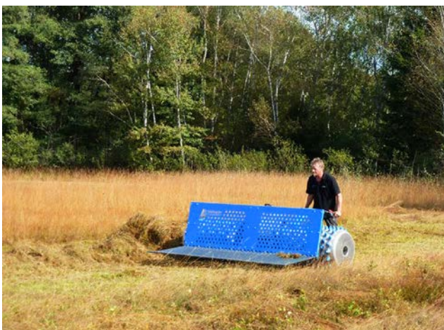
Abb. 7: Neu entwickelte Techniken ermöglichen die effizientere Bewirtschaftung von Nasswiesen. Beispielsweise montierbare Räumschilde/Heuschieber und funktionsgesteuerte Balkenmäher mit einer Arbeitsbreite von bis zu sieben Metern ermöglichen die Bewirtschaftung selbst von kaum noch begeharen Feuchtfelder (Fotos: Uwe Kießling).
