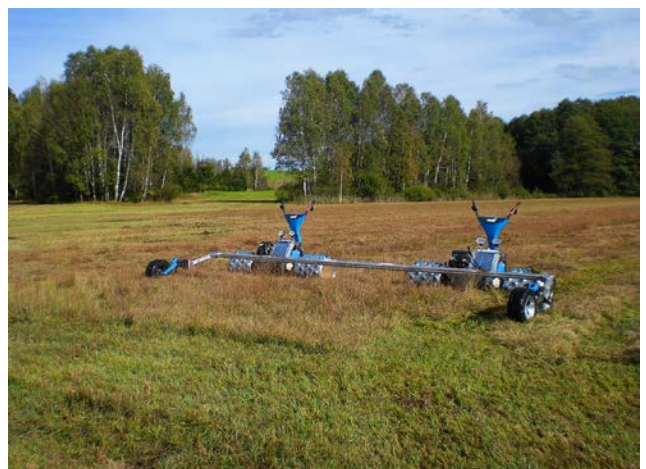
Abb. 7: Neu entwickelte Techniken ermöglichen die effizientere Bewirtschaftung von Nasswiesen. Beispielsweise montierbare Räumschilde/Heuschieber und funktionsgesteuerte Balkenmäher mit einer Arbeitsbreite von bis zu sieben Metern ermöglichen die Bewirtschaftung selbst von kaum noch begeharen Feuchtfelder (Fotos: Uwe Kießling).
