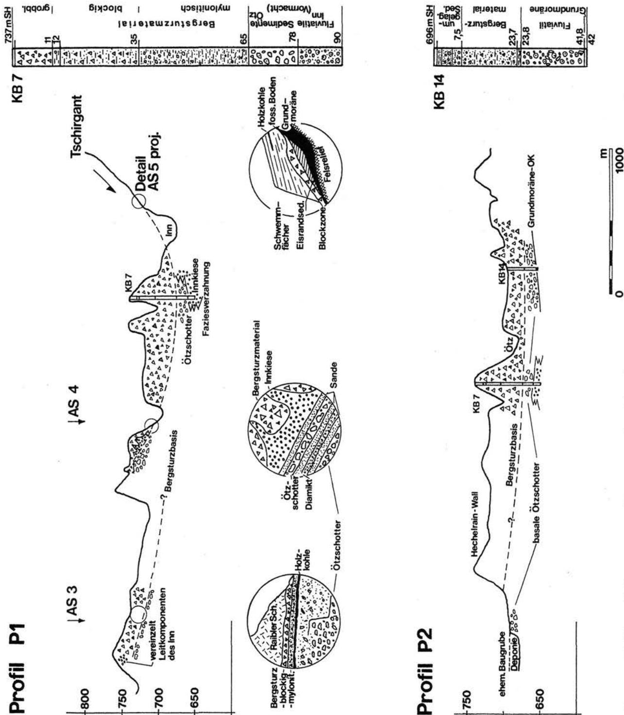
Abb. 3 Tschirgant Bergsturz - Prognose des Internbaus
