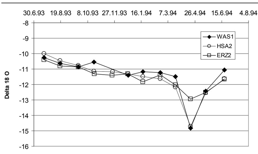
Abb. 4: Sauerstoff-18-Ganglinien der Wässer vom Wasserboden (WAS1), der Hinterseequelle (HSA2) und des Wassermannloches (ERZ2).
