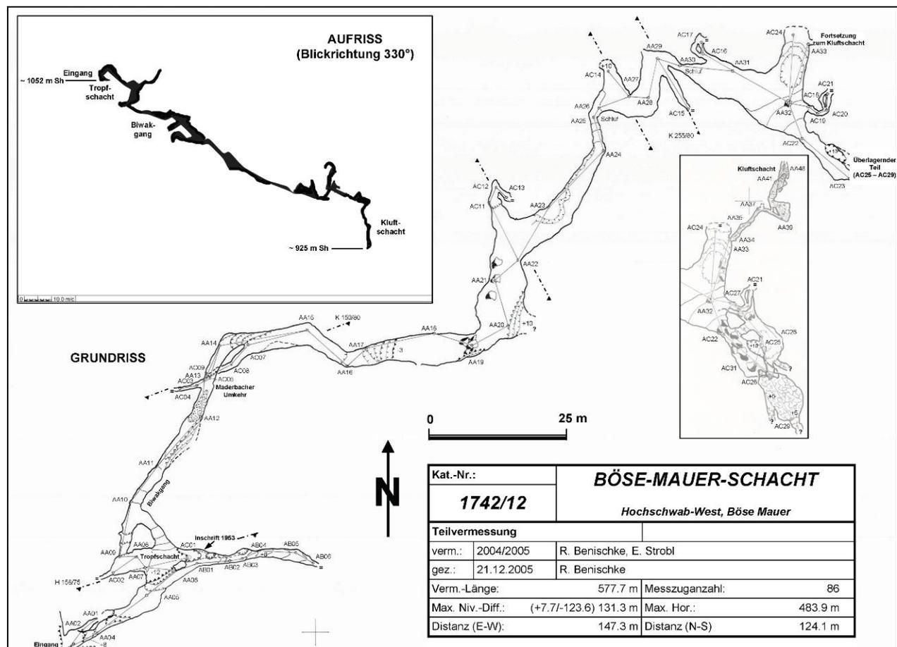
Abb. 7: Höhlenplan des Böse-Mauer-Schachtes aus BENISCHKE & STROBL, 2006. Die Anlage der Höhle erfolgte vor allem im südwestlichen Teil entlang von etwa SW–NE-streichenden Klüften bzw. Störungen.
