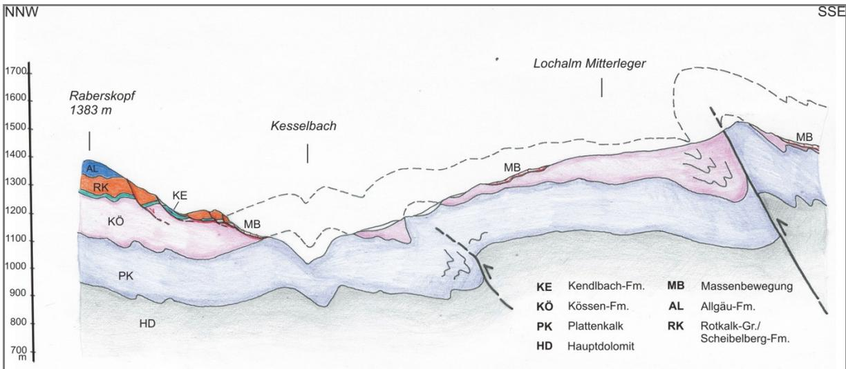
Abb. 7: Geologischer Profilschnitt zwischen Raberskopf im Norden und Lochalm-Mitterleger im Süden; Erläuterung im Text.
