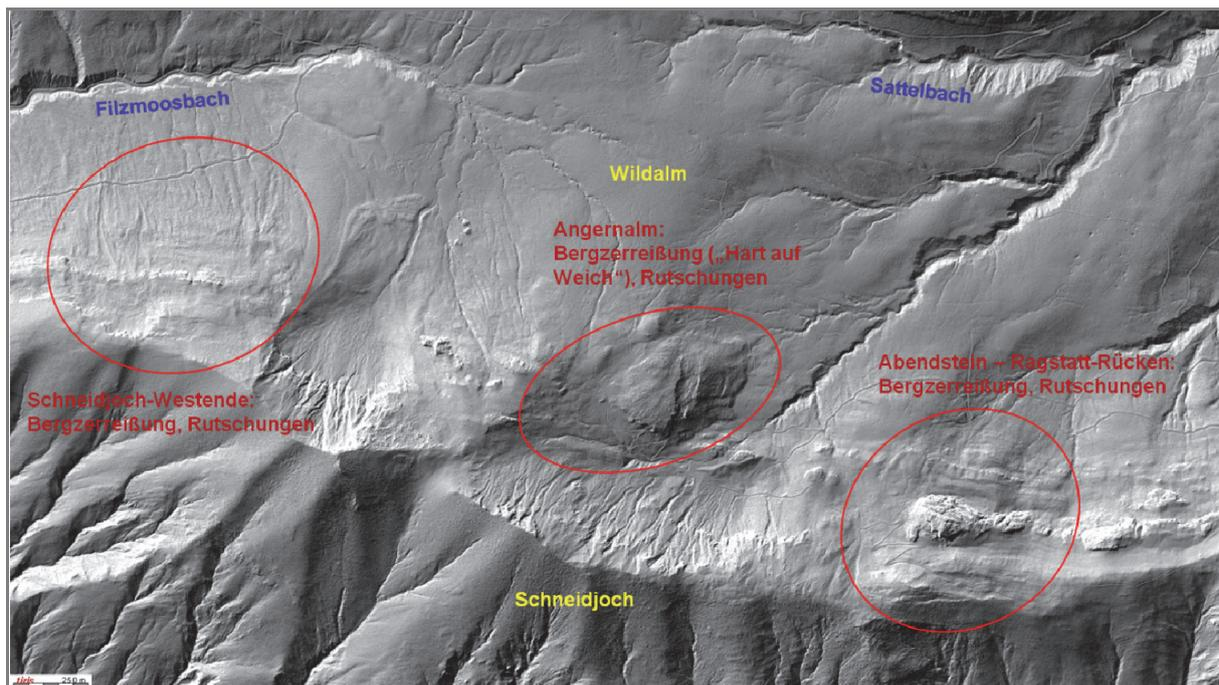
Abb. 18: Verbreitung gravitativer Massenbewegungen (schematisch umgrenzt) in den N-exponierten Hngen des Schneidjochs (Sdschenkel der Thiersee-Synklinale); Laserscanning Tirol © Land Tirol.
