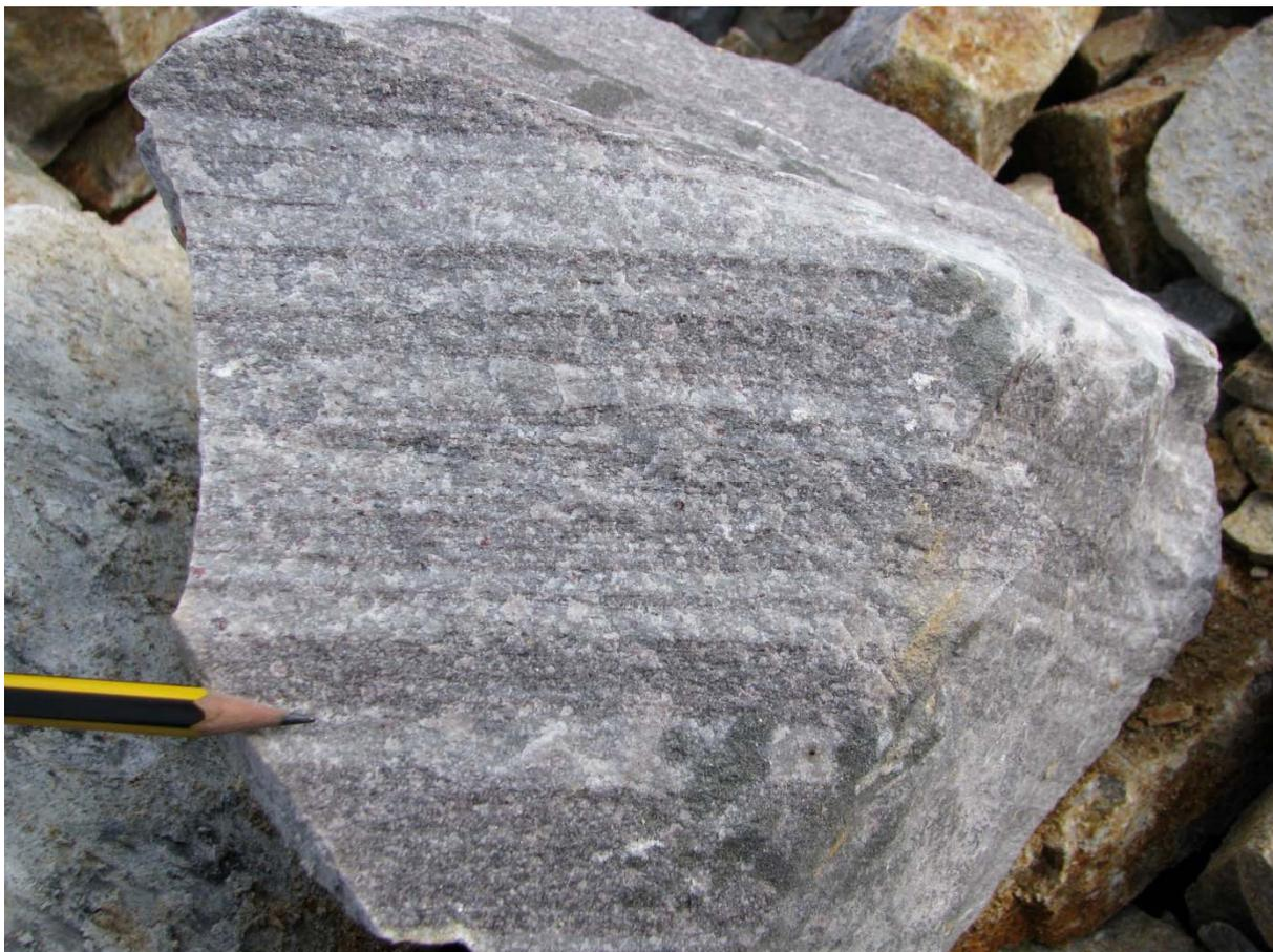
Abb. 1: Feinkörniger Moldanubischer Granulit mit weiß-grauvioletter Bänderung und rotem Granat. Die feine Bänderung ist durch wechselnden Biotitgehalt und mylonitische Deformation verursacht (Probe ML13-37-2, Bildbreite 15 cm; Steinbruch der Firma Marchart, Karlstetten).
