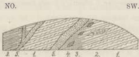
Fig. 16. Durchbruch an der Bahnstrecke nördl. von Malenie, am Nordwestabhange des Bor: 1. körnig-faseriger Biotitgneis, 2. Linse eines Pegmatitgemenges mit Turmalin, 3. feinschieferiger Gneis, 4. Amphibolknollen, 5. Gänge von Granitaplit.
