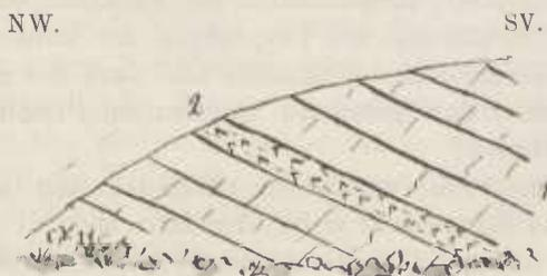
Fig. 10. Durchschnitt des Urkalkfelsens bei Zuzlawitz. 1. Urkalkbänke, 2. Lagergang des grobkörnigen Biotitgranits.
