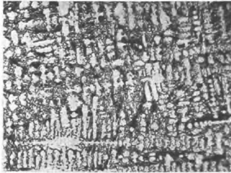
Abb. 2. Wie 1, jedoch geringere Vergrößerung. Die weißen Dendriten der Matrix treten deutlicher neben den beiden dunklen Boriden hervor
