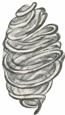
Abb. 10. Weiterer Zerfall in einzelne Schichten und Zunahme der Auffaserung bei stärkster Druckwirkung.
