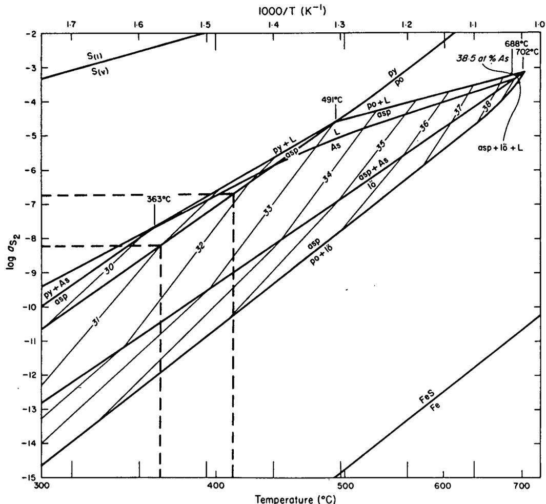
Abb. 29. Das Arsenopyrit-Stabilitätsfeld in der Schwefelaktivität-Temperatur-Projektion. Isoplethen in Atom-% As. Alle Phasenbeziehungen im Gleichgewicht mit der Gasphase (aus KRETSCHMAR & SCOTT, 1976). Die unterbrochenen Linien begrenzen den Stabilitätsbereich für die Arsenopyrit-Chemismen in Tab. 5. py = Pyrit; po = Pyrrhotin; asp = Arsenopyrit; lö = Löllingit; L = Schmelze; S<sub>g</sub>, S<sub>v</sub> = Schwefelschmelze bzw. -dampf.
