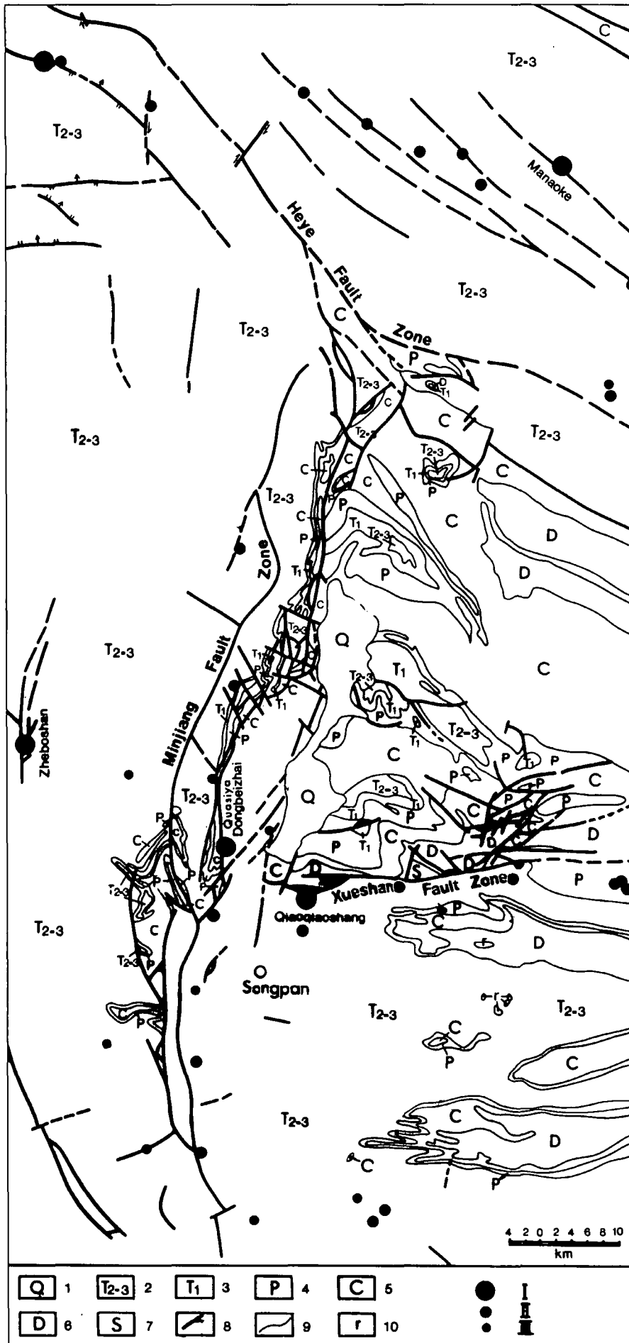
Abb. 5. Geologische Skizze des „Ostgebietes“. 1 (Q) = Quartär, 2 (T2-3) = Mittel- bis Ober- trias, 3 (T1) = Untertrias, 4 (P) = Perm, 5 (C) = Karbon, 6 (D) = Devon, 7 (S) = Silur, 8 = Ver- werfung, 9 = Schichtgrenze, 10 (r) = Intrusion, I = große Goldlagerstätten, II = kleine Goldlagerstätten, III = Goldvorkommen.
