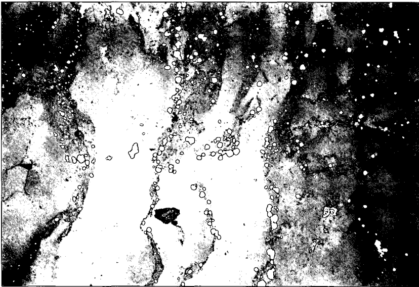
Abb. 45. Reliktgefüge aus dem primären Anlagerungsstadium in Form von Mikrofeinschichten (vertikal), bestehend aus Sericit (schwarzgrau) mit Pyrit (weiße Kriställchen), Spuren von Rutil, Grafit, und Quarzit (verschieden grau) mit Calcit (verschieden weißgrau), Spuren von Realgar (grauweiß) und Rutil. Polierter Anschliff, 1 Nicol. Bildausschnitt 0,9 x 0,6 mm.
