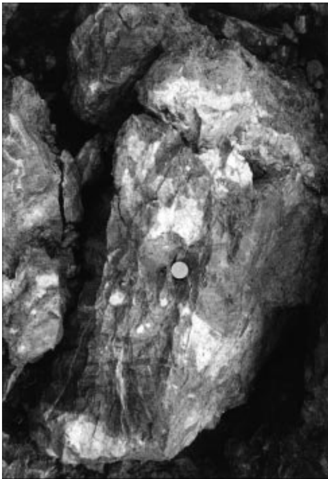
Abb. 96. Grobspätige Nester von jungen alpidischen Sammelkristallisaten von Siderit, Ankerit, Quarz und Calcit im feinkristallinen Sideriterzkörper, verbunden mit Metasomatose im Kalknebengestein.
