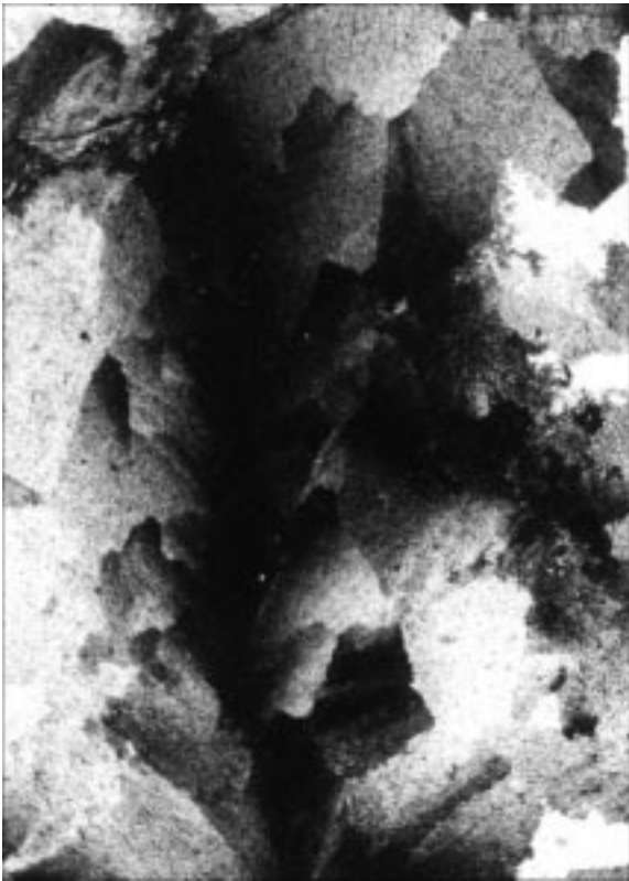
Abb. 98. Eines der typischen Sideritwachstumsgefüge im polarisierten Durchlicht. Dünnschliff, Nicols +; natürl. Größe 3,36×2,21 mm.
