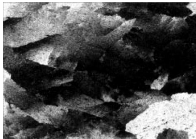
Abb. 84. Das Erz der schlauchförmigen s -diskordanten Erzkörper besteht häufig aus einem grobspätigen Sideritkorngefüge mit stark undulösen xenomorphen bis hypidiomorphen Komponenten, häufig auch begleitet von grobkörnigem Quarz (nicht im Bilde) und Verdrängungsresten von Calcit des Kalksteins (nicht im Bildausschnitt). Dünnschliff, Nicols x; natürl. Größe 3,36×2,21 mm.
