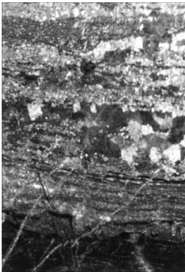
Abb. 71. Wechsellagerung verschieden feinkörniger Ankerit-Sideritlaminae mit Quarz und feinkristallinem Siderit mit Quarz- S_1 . Außer lokalen Unkonformitäten an primären Sedimentbauzonen bestehen am unteren Bildrand (grauschwarz infolge Sericitfilz mit Pyrit) syndiagenetische Stoffverlagerungen an Suturen. Haarrisse mit Quarz verheilt. Dünnschliff, Nicols II; natürl. Größe 15,5×8,5 mm.
