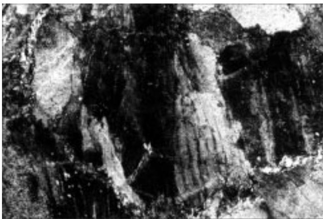
Abb. 89. Infolge starker tektonischer Beanspruchung zwillingslamellierte Sideritkristalle eines grobkristallinen Erztektonitgefüges. Dünnschliff, Nicols +, natürl. Größe 3,36×2,21 mm.
