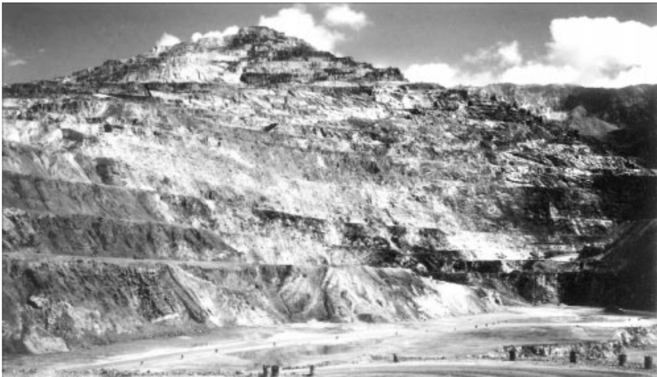
Abb. 32. Erzberg-Totale von Etage Sybold aus gesehen mit der Auflage der auf Devon transgredierenden Präbichl- und Werfener Schichten (links unten). Im Gipfelbereich des Bildes kommt die Steilstellung des Faltenostflügels und die Schichtenverbiegung auf flaches W-Fallen im Mittelteil deutlich zur Übersicht. Mit Annäherung an den Faltenkern (rechter Bildteil) ist unterschiedlich flaches Einfallen der Schichtung und die Überleitung zum E-fallenden Faltenwestflügel (rechter Bildrand im Dunkel) nur undeutlich erkennbar.
