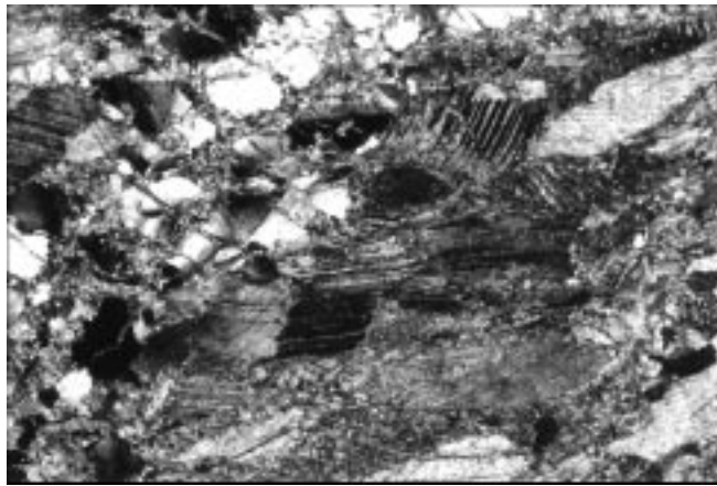
Abb. 14. Sauberger Kalk. Mechanisch stark durchbewegter Calcitmarmor (gelängte Körner, verbogene Zwillingslamellen) mit ruptuell deformierter Quarzfeinlage (weiß, grau, schwarz; z.T. undulöse Auslöschung). Dünnschliff. Nicols +; natürl. Größe 3,36×2,21 mm.
