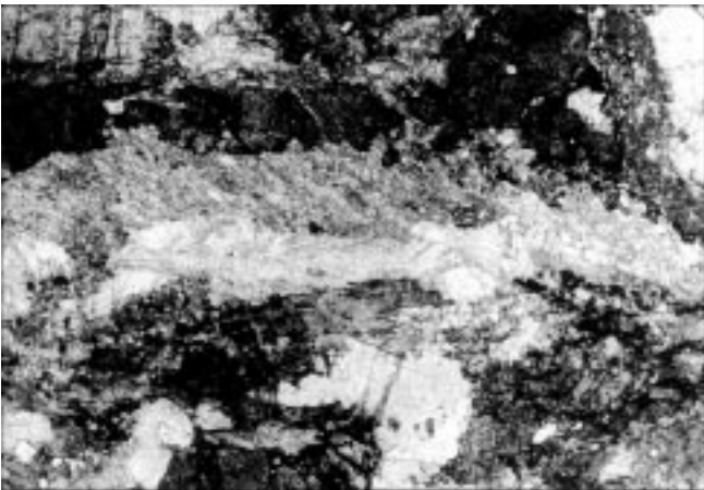
Abb. 79. Ein häufiger Fall deformierter Grenzen zwischen Sideritaggregaten (dunkel) und Kalkschiefer (Sauberger Kalk, hell). Sauberger Kalk, teils mikritisch (grau), teils grobspätig (grauweiß), allenfalls mit Sericit und Quarz, am metasomatischen Kontakt mit grob-spätigem Siderit (grau bis grauschwarz, undulös). Starke nachkristalline mechanische inter- und intragranulare Durchbewegung des gesamten Gefüges. Dünnschliff, Nicols +, natürl. Größe 3,36×2,21 mm.
