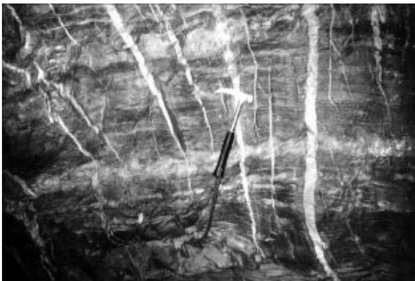
Abb. 51. Schichtdiskordante, mit Quarz und Scheelit vererzte Zerrklüfte in laminiertem, Ankerit und Pyrit führenden Chlorit-Sericit-Quarzit-schiefer des Erzlagere V4.
