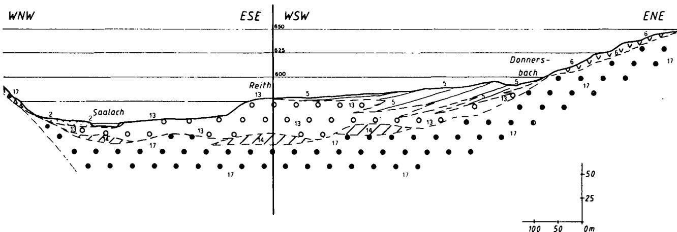
Abb. 4: Geologisches Querprofil im Abschnitt Reith, Lage und Legende siehe Abb. 2.
