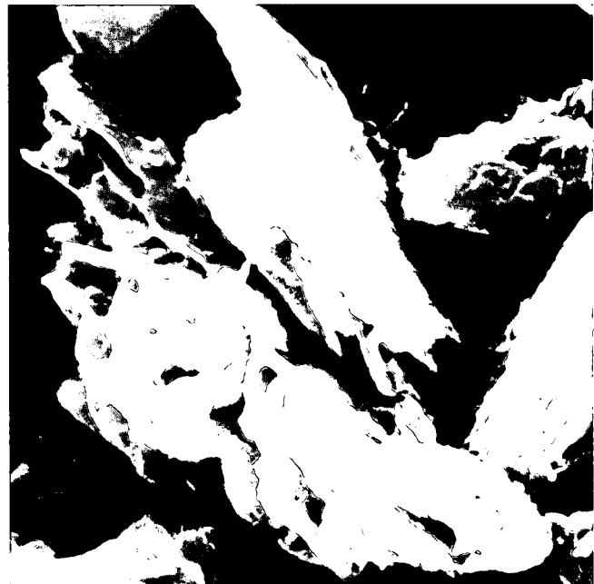
Abb. 10: REM-Aufnahme des Umwandlungsstadiums Illit zu Montmorillonit (Fehring).
