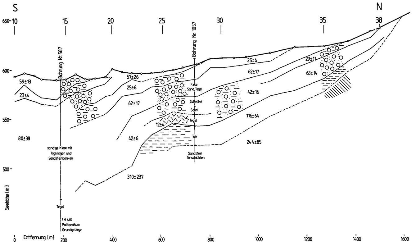
Abb. 2: NS-Profil einer geoelektrischen Tiefensondierung im Gebiet Bürgerwald/Tregistsattel
