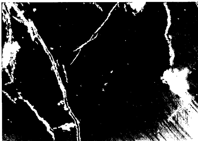
Abb. 3: Polysynthetische, feinlamellare Zwillingsbildung in einem Kupferkieskorn, tectonisch verbogen. Entlang von Rissen sind Covellin (weiß) und Limonit (grau bis weiß) ausgeschieden. Polierter Anschliff vom Rauhen Kopf, Nicols +.
