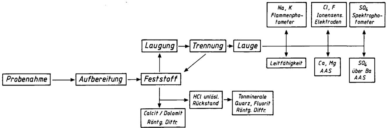
Abb. 1: Schematischer Überblick über Analysengang und Analysenmethoden.
