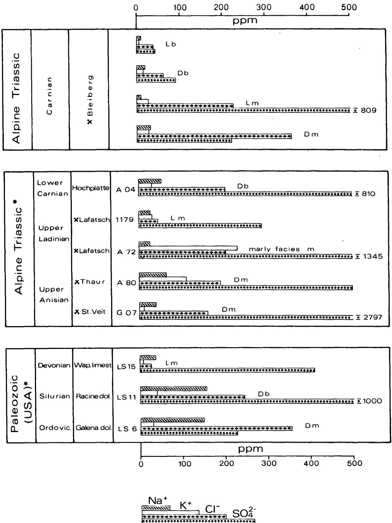
Abb. 2: Konzentration wasserlöslicher Komponenten in unverzerten und verzerzten Gesteinen der Blei-Zink-Lagerstätte Bleiberg-Kreuth (arithmetische Mittelwerte) im Vergleich mit Werten nach SCHNEIDER<sup>•</sup> (1969) und LAMAR & SHRODE (USA)\* (1953). L = (limestone) Kalke; D = (dolomite) Dolomite; b = (barren) unverzert; m = (mineralized) verzerzt.
