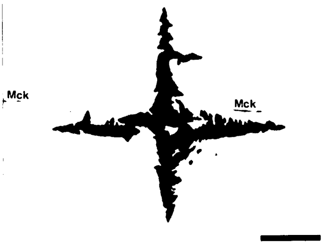
Abb. 14. Schön entwickeltes und verzweigtes Zinkblendesternchen, orientiert zum Kupferkiesgitter gewachsen. Mck = Mackinawit. Polierter Anschliff, Knappenhof (Nr. 91). Ölimmersion, Nicols \parallel , Marke = 0,01 mm.
