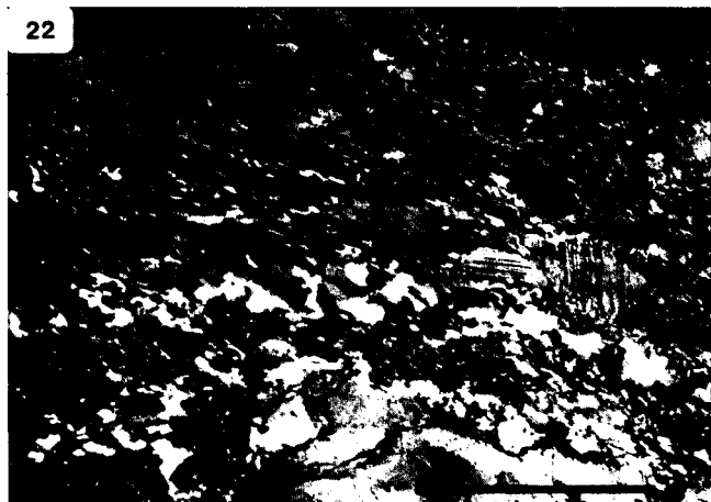
Abb. 22. Mikrobild aus dem Zinkblendephyllonit der Abb. 23, in dem die starke Durchbewegung und weitgehende Rekristallisation von Calcit (licht- bis schwarzgrau) sehr deutlich zum Ausdruck kommt. Zinkblende erscheint weiß bis grauweiß.
