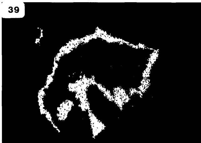
Abb. 39. Silber-Verteilungsaufnahme ( \text{Ag K}_\alpha ) im Erz der Abb. 37. Silber ist nur im Freibergit, jedoch nicht im Bleiglanz nachzuweisen.
