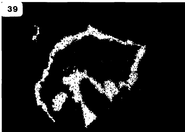
Abb. 39. Silber-Verteilungsaufnahme ( Ag K_{\alpha} ) im Erz der Ab. 37. Silber ist nur im Freibergit, jedoch nicht im Bleiglanz nachzuweisen.
