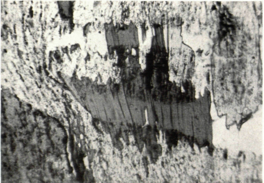
Abb. 3. b Schliff, Biotit mit (001) fast in s
