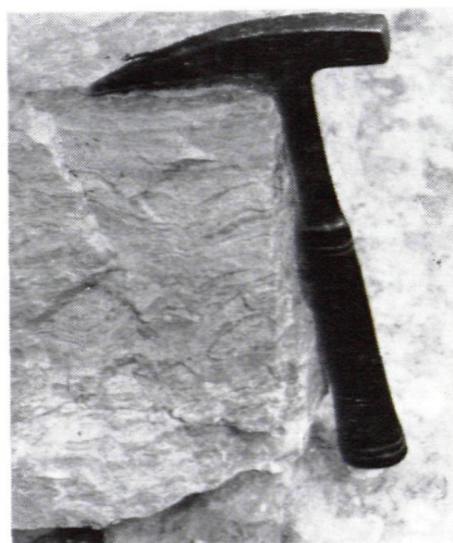
Abb. 5: Ein Beispiel aus den Zwischenschichten mit deutlicher Feinschichtung von Kalk- und Dolomitlagen
