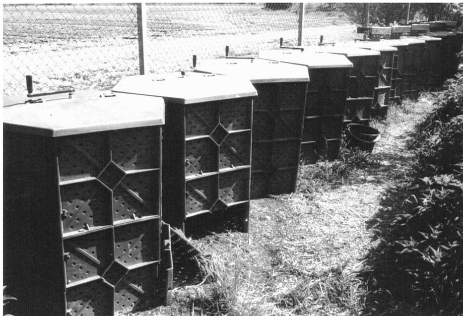
**Abb. 1:** Versuchsanordnung mit den 12 Rührkompostern; im Vordergrund sind die sechs manuell umgesetzten, im Hintergrund die sechs elektrisch betriebenen Komposter zu sehen.
