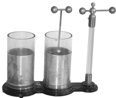
Abb. 7: Elektrische Maßflasche nach Lane, um 1900 HTL Innsbruck
