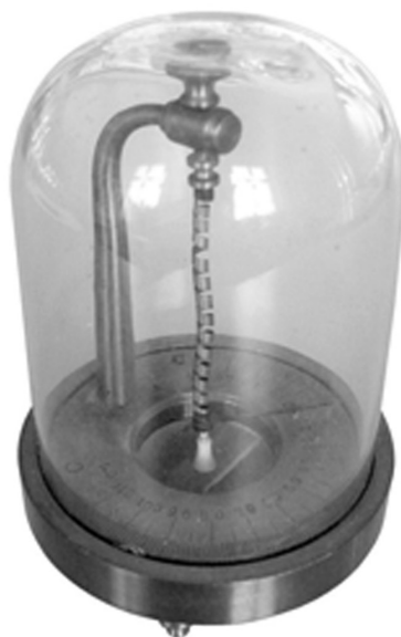
Abb. 8: Trimetall-Thermometer nach Breguet, um 1880 BORG Innsbruck
