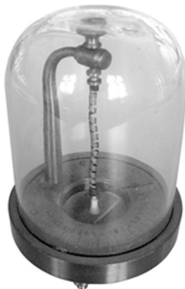
**Abb. 8:** Trimetall-Thermometer nach Breguet, um 1880
