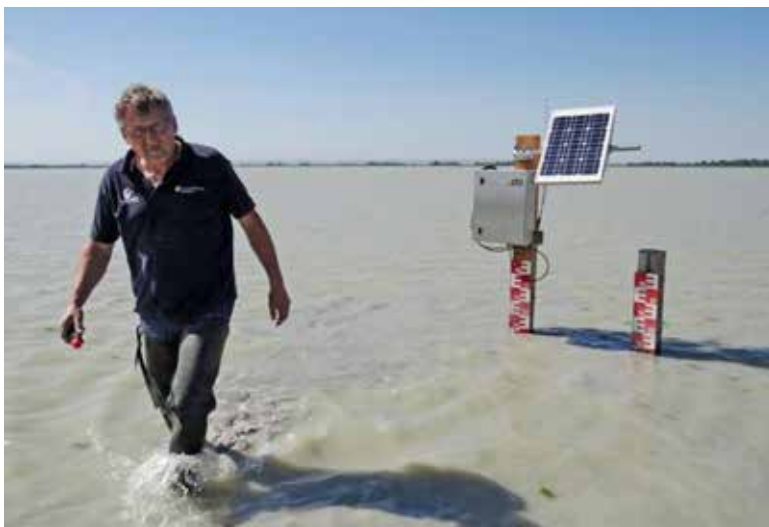
Die Biologische Station betreibt OnLine-Messsonden, um physikalisch-chemische Dauermessungen an einigen Salzlacken durchzuführen. Dadurch soll die Funktionsweise der Lacken besser verstanden werden.
